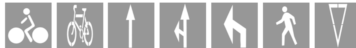
Ciclista 80x80 cm Bicicleta de 80x80 cm Flecha recta de 135x50 cm Flecha bidireccional de 135x75 cm
