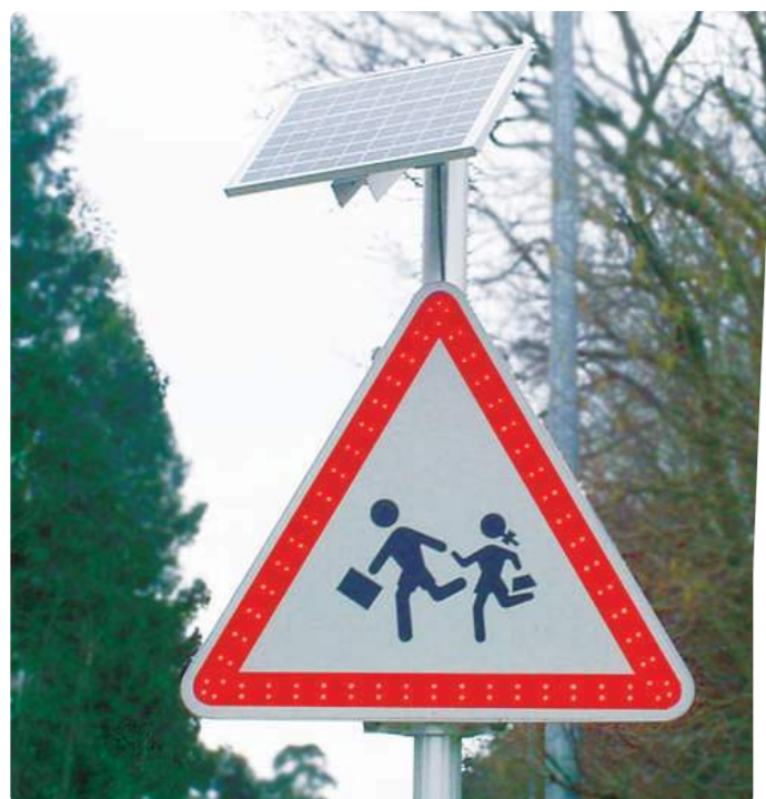
Señal con alimentación solar, en poste Ø 90 mm, orientación sur e inclinación de 60° de la placa solar.
