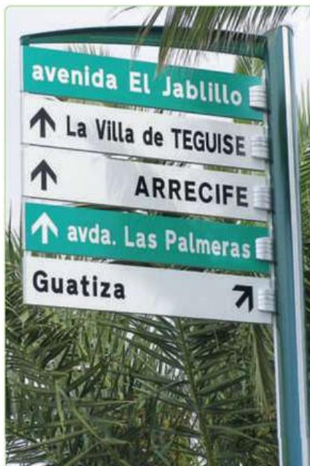
Apueste por la altura de las letras. Si la velocidad reglamentaria es inferior a los 50 km/h, elija una altura de 80 mm
