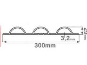
**Protector para Paredes en Bobina diagonal de espesor 20 mm dura.** Protector ignífugo de alta resistencia y durabilidad adaptable a esquinas en ángulo recto, chaflán, columnas circulares, paredes, fondos de plazas en garajes, industrias... Fácil colocación y limpieza. Composición: espuma de polietileno reticulado SR de 20mm de grosor adherida mediante foamización a un tejido textil de PVC.
