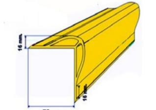
**Protector de Rampas y Paredes Tiple Hueco de PVC.** Antichoque señalizador y protector de alta resistencia, gracias a su triple hueco, para paredes, rampas y puertas. Gran durabilidad y fácil limpieza.
