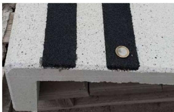
Hormigón armado compuesto por: cemento blanco-gris, árido seleccionado granítico-silíceo, armadura de acero tipo trefilado de 4 mm de diámetro, acabado ligeramente decapado, rugoso e hidrofugado, dos franjas de carborúndum de 5 cm. Antideslizante, de sección variable.
